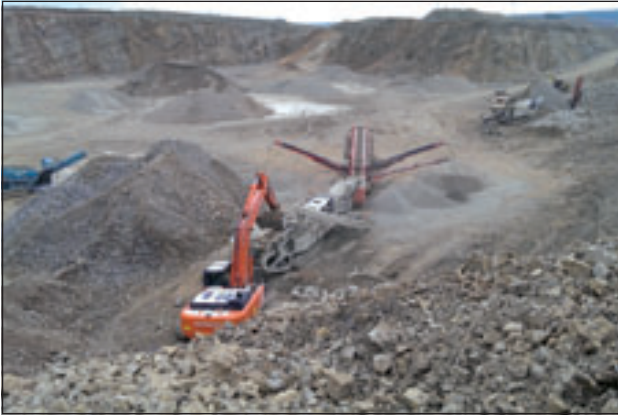
Praca zakładu przerobczego w wyrobisku – ograniczenie hałasu ścianami wyrobiska
