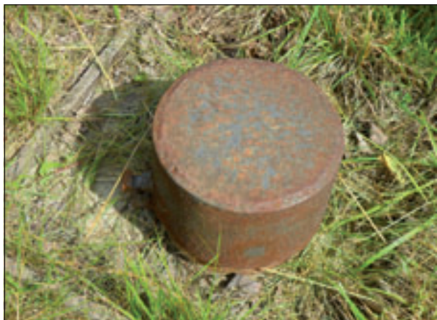
Piezometr na zrehabilitowanym składowisku
