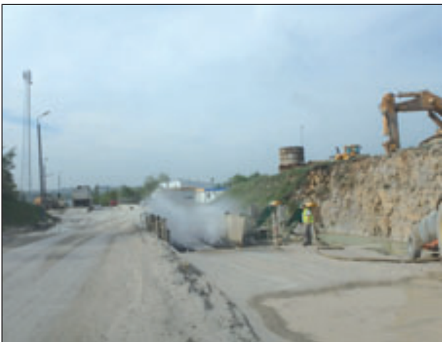
Ograniczenie zapylenia – myjka do czyszczenia pojazdów wyjeżdżających z kopalni
