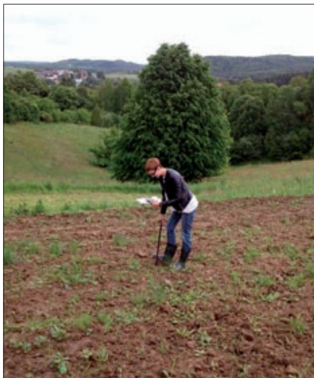
Prawidłowy sposób pobierania próbek glebowych z UR przy użyciu laski Egnera
