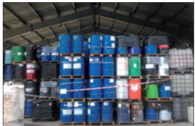
Magazyn odpadów niebezpiecznych przeznaczonych do termicznego przekształcania
